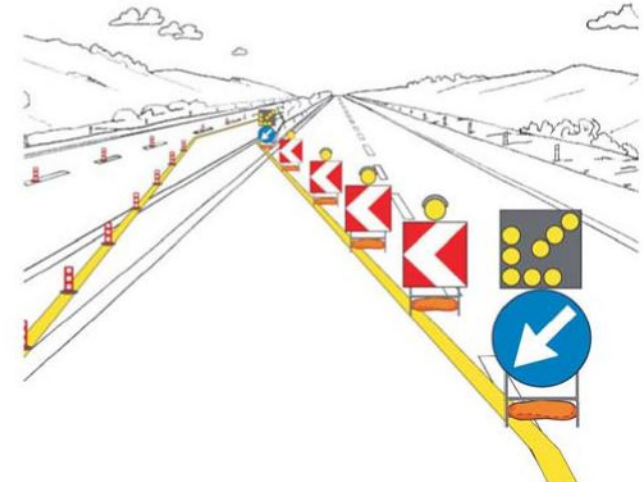
TESTATA DI DEVIAZIONE PER CANTIERE > 7 GIORNI
